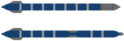
Grafik: Oben Monotank, unten Zwei-Segment-Bauweise
