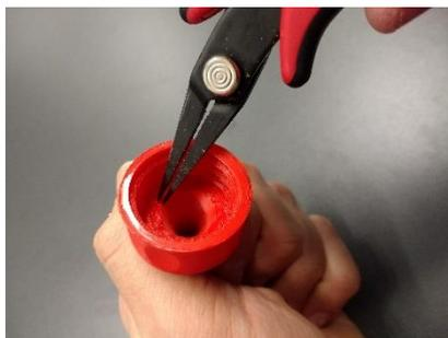
Heißklebstoff auf den Innenboden füllen und den Dichtungsring einlegen. Anschließend die Düse auf eine Flasche fest aufschrauben und warten bis der Klebstoff trocknet. Nun können die Klebereste entfernt werden.
