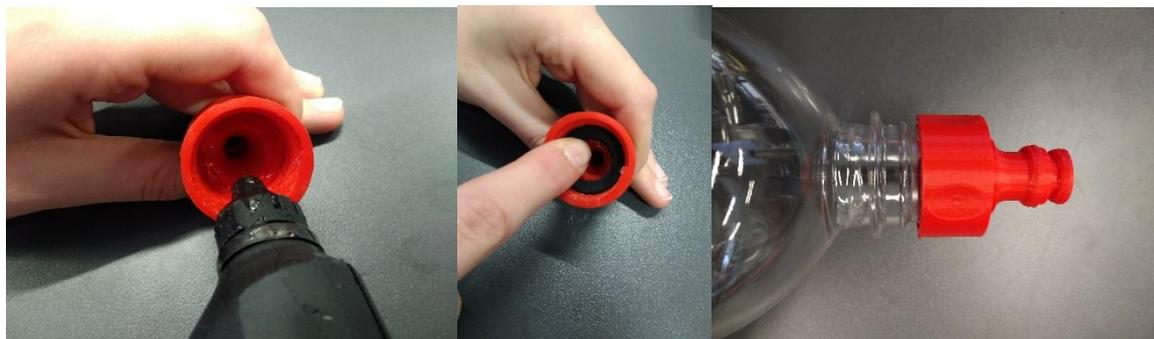
Die O-Ring Dichtung anbringen. Die Düse vor dem Einsatz unbedingt in einer sicheren Umgebung auf Dichtigkeit überprüfen. Beim Testen auch über den geplanten Einsatzdruck hinausgehen. Schutzbrille und gegebenenfalls Gehörschutz tragen.
